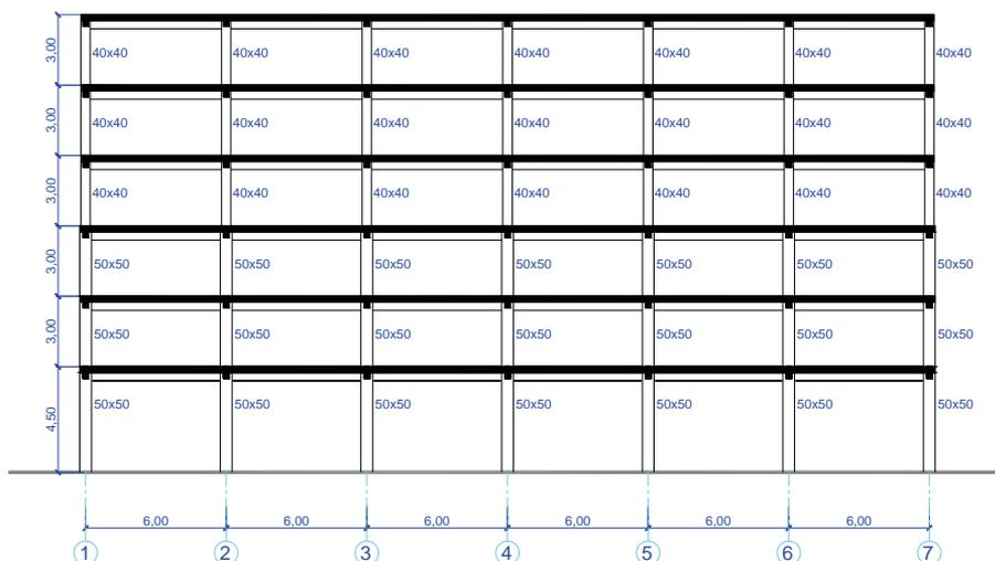
Figura 6.2 Alzado de pórtico de seis niveles
