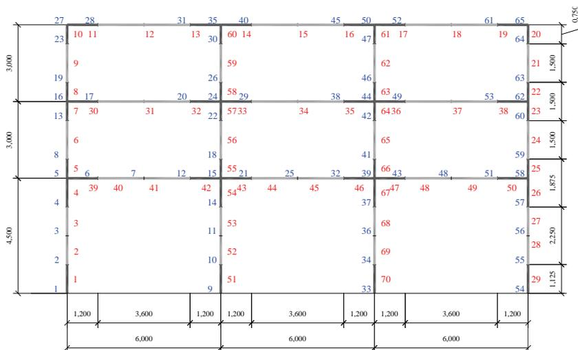
Figura 7.4 Discretización típica de pórtico de carga
