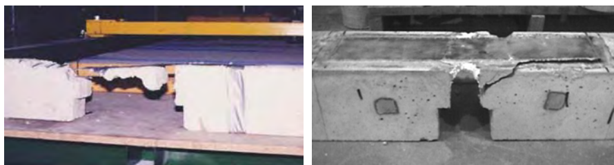
(a) Fractura por corte en el hormigón [44] (b) Fallo en la interfaz epoxi- hormigón y fractura [45]
