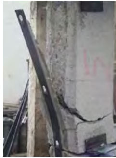
(a) Fractura y fisuración en el hormigón (b) Fallo en la interfaz epoxi- hormigón
