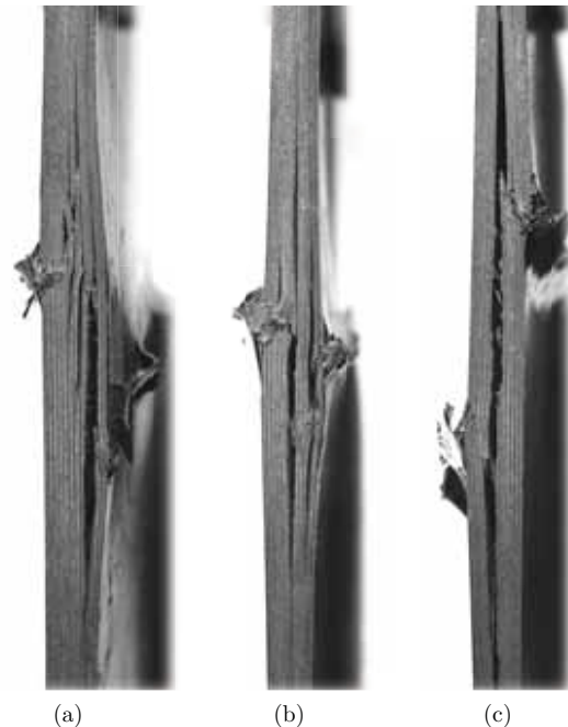
Figura 6.9: Secciones transversales de los laminados con deslaminación artificial (a) 66/06L6/D50E10, (b) 68/08L6/D50E20 y (c) 72/12L6/D70E20 tras el ensayo de compresión. La rotura del espécimen (c) se asocia al segundo modo de pandeo.
