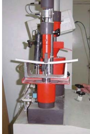
Figura 3.4-1: Montaje del ensayo a flexión de un laminado compuesto (Tomado de Correia 2004).
