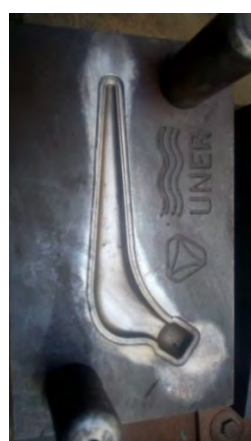
Figura 56: La figura muestra las partes de la matriz para forjado en caliente del vástago diseñado por optimización computacional, a) parte inferior, b) parte superior.
