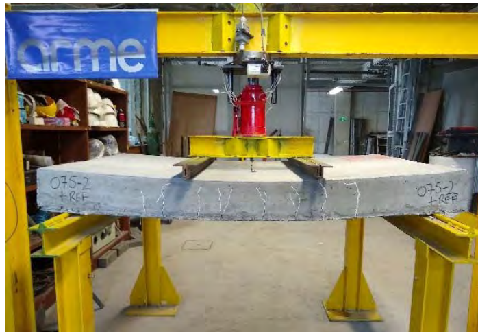
Figura 118: Montaje de laboratorio losa con lamina colaborante.
