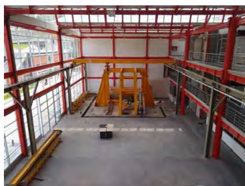
Figura 122: . Pórtico de reacción y área de ensayos del laboratorio de estructuras.
