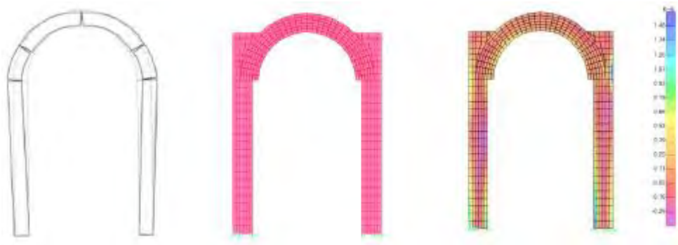
Figura 144: Diagrama del sistema de arco (izquierda), modelo matemático (centro) y resultado de esfuerzos (derecha).
