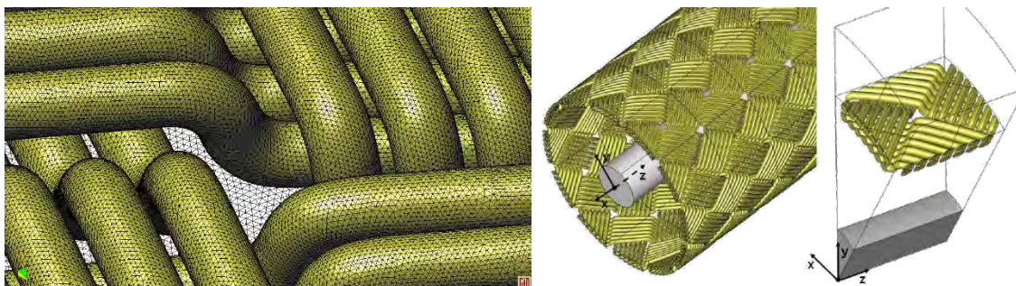
Figura 17: Trenzado de cable coaxial (proyecto HIRF-SE)
